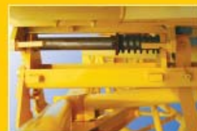
副臂自动插销装置 Jib auto-pin device
