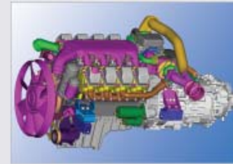
奔驰欧 III 型电喷发动机 Benz engine, Euro III, electronic injection
